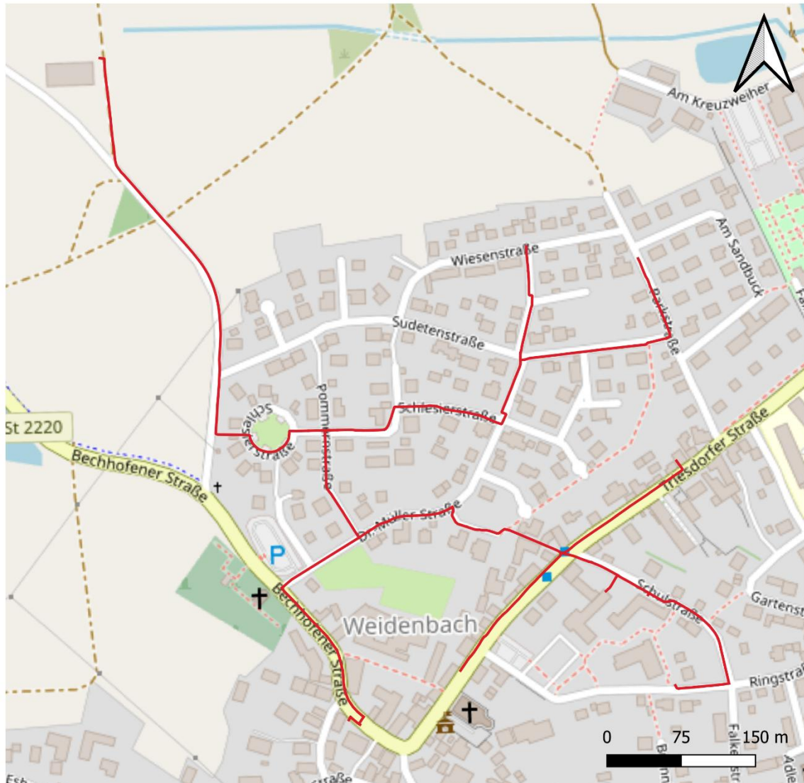
Abbildung 10 Geplantes Wärmenetz Weidenbach
