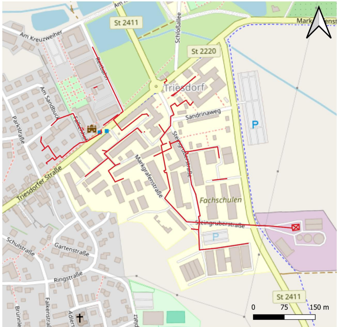
Abbildung 9 Bestehendes Wärmenetz Triesdorf
